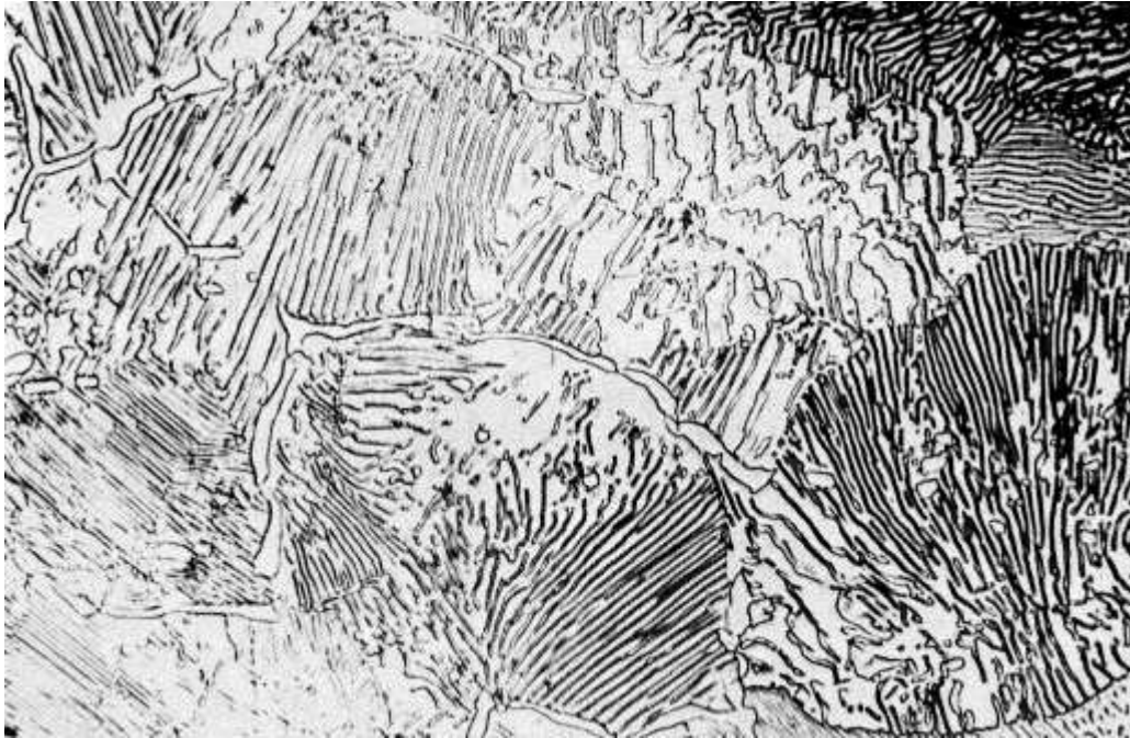
Bild 16: Übereutektoider Stahl mit ca. 1,0% C, Vergrößerung 500-fach.
